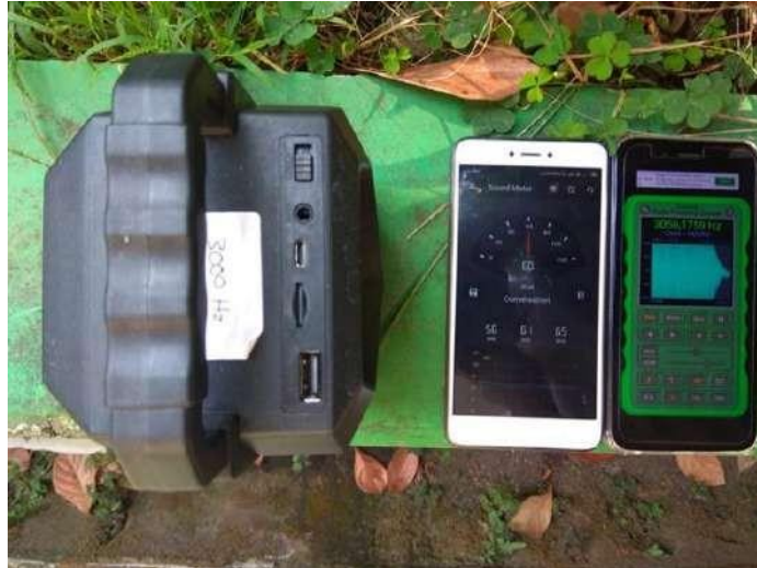
Gambar 7. Validasi bunyi dengan aplikasi sound level meter.
