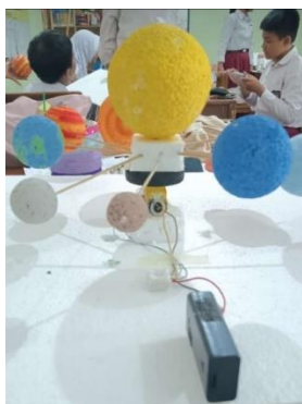
Gambar 3. Siswa membuat proyek tata surya menggunakan rangkaian dinamo, baterai, lampu, dan kabel supaya karyanya dapat bergerak memutar dan menyala
